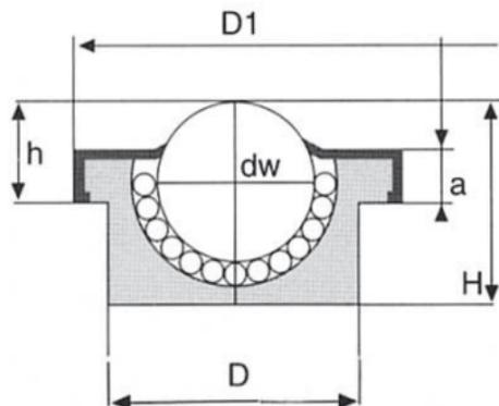
Массивный корпус из углеродистой стали, изготовленный из цельного бруска, обработанного на станке, с колпаком из штампованного листа и разгрузочным отверстием на дне. Пылезащитная прокладка изготавливается только на заказ.
