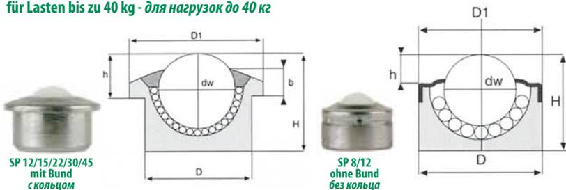
Большой основной шар из POM - полиацеталь (Дерлин). По причине легкости пластмассового шарика, пылезащитная прокладка не была установлена в моделях SP-22/30/45 с целью обеспечения свободного перемещения большого основного шара. Можно установить прокладку по требованию в моделях специального применения. Рабочая температура: +60°C. Исполнение непригодно для применения с перевернутым шариком. Разгрузочное отверстие встроено во все типы моделей (за исключением SP-8).
